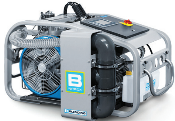
MARINER 320-OX mit Blending Panel, Elektromotor, 4 Füllschläuchen mit Nitrox-Anschlüssen (serienmäßig)
