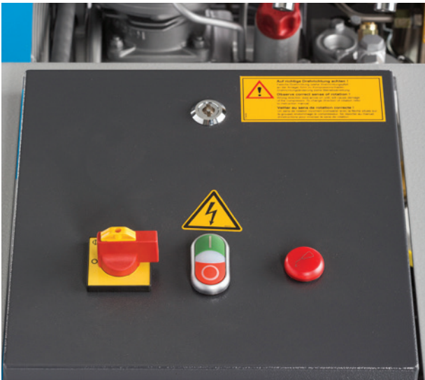
Kompressorsteuerung des MARINER, mit Hauptschalter, Ein- und Ausschalter sowie Meldeleuchte für Ölstands-/Drehrichtungskontrolle
