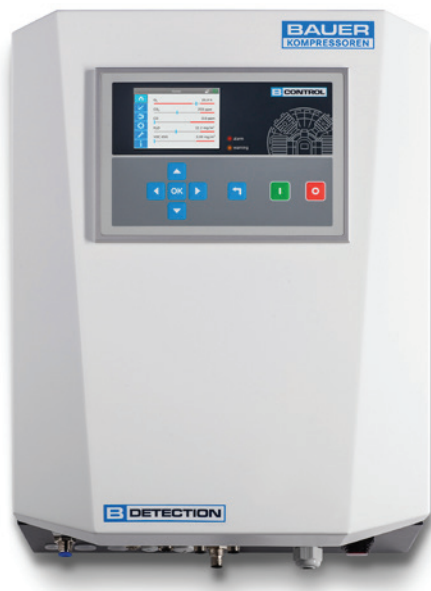
B-DETECTION PLUS Online-Gasmessgerät: Kontinuierliche Messung von CO, CO 2 und O 2 sowie optional absoluter Feuchte und Restöl (VOC) 1
